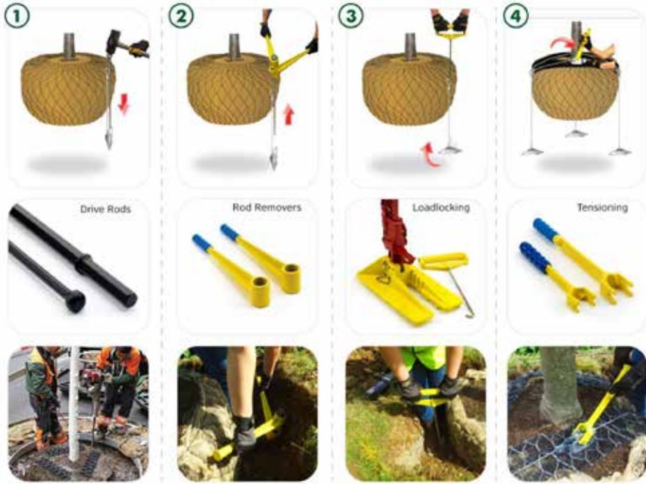
طريقة التدعيم تحت الأرضية الحديثة للأشجار. المصدر www.platipus-anchors.com
